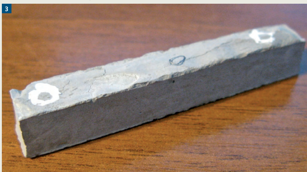
3. CAMPIONE di calcestruzzo polimerico esaminato (sezione: 10 \times 10 \text{ mm}^2 ).
